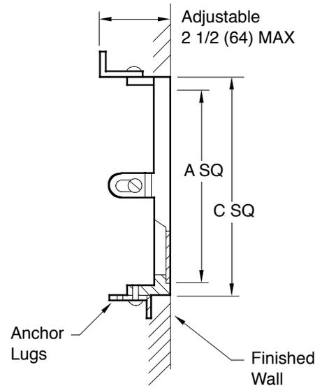
Fig. 4735 FLUSH-WITH-WALL COVER
