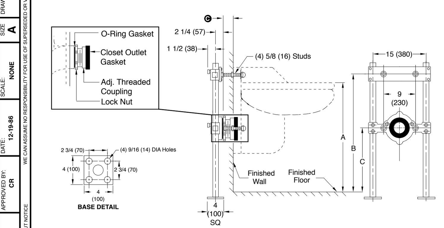
Fig. 0913. .... 3" (80) OUTLET CONNECTION
